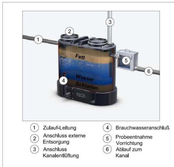
Bild2: Klassischer Fettabscheider zur Komplettentsorgung. Er funktioniert nach dem Prinzip der Phasentrennung: Fett schwimmt oben. Feststoffe sinken nach unten. In der Mitte das Wasser.
